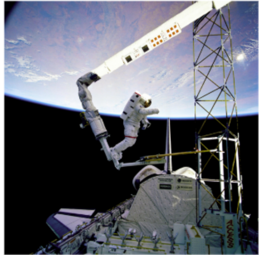
Astronauta Jerry L. Ross, anclado al reposapiés del RMS, se acerca al dispositivo ACCESS, que parece una torre.
